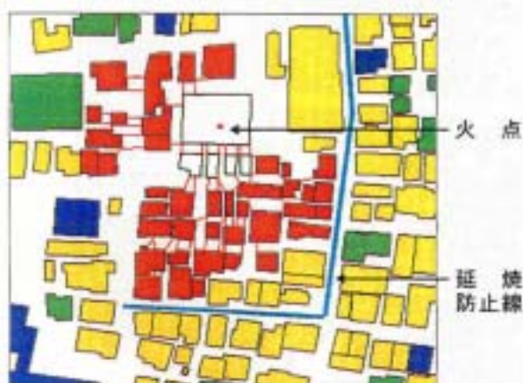
▲ 消防力投入後の延焼状況
