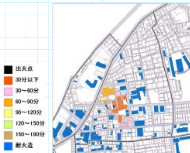
図 2.3.35 区画道路(幅員 8m+6m) 整備モデルによる延焼シミュレーション結果
