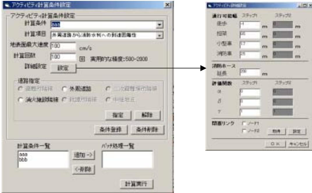
計算条件欄に、設定する計算条件の名称を入力し、計算項目、地表面最大速度、計算回数を設定します。
